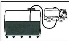
① Die Leitungen werden demontiert, der Domdeckel geöffnet, das saubere Heizöl wird abgepumpt und zwischengelagert (bis zu 10.000 Ltr.).
