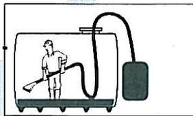
② Der Tank wird fachgerecht gereinigt. Der Ölschlamm wird beseitigt und von uns als Sondermüll nach dem Abfallbeseitigungsgesetz entsorgt.
